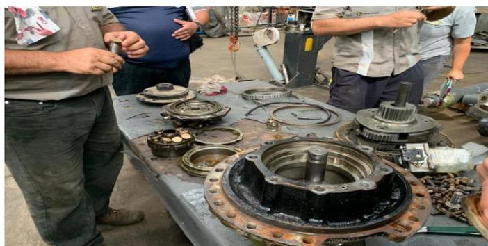
**Imagen 4. Diagnóstico del sistema de rodaje de la excavadora.**
